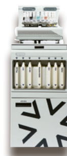
Aparat BenchMark GX · system do automatycznego barwienia metodą IHC/ ISH
